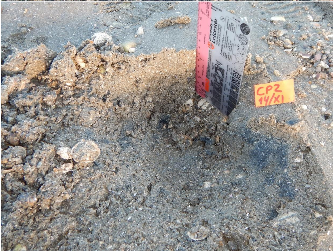
Sustrato con la capa superficial ennegrecida por falta de oxígeno y sin ella después de un tratamiento de remoción.
