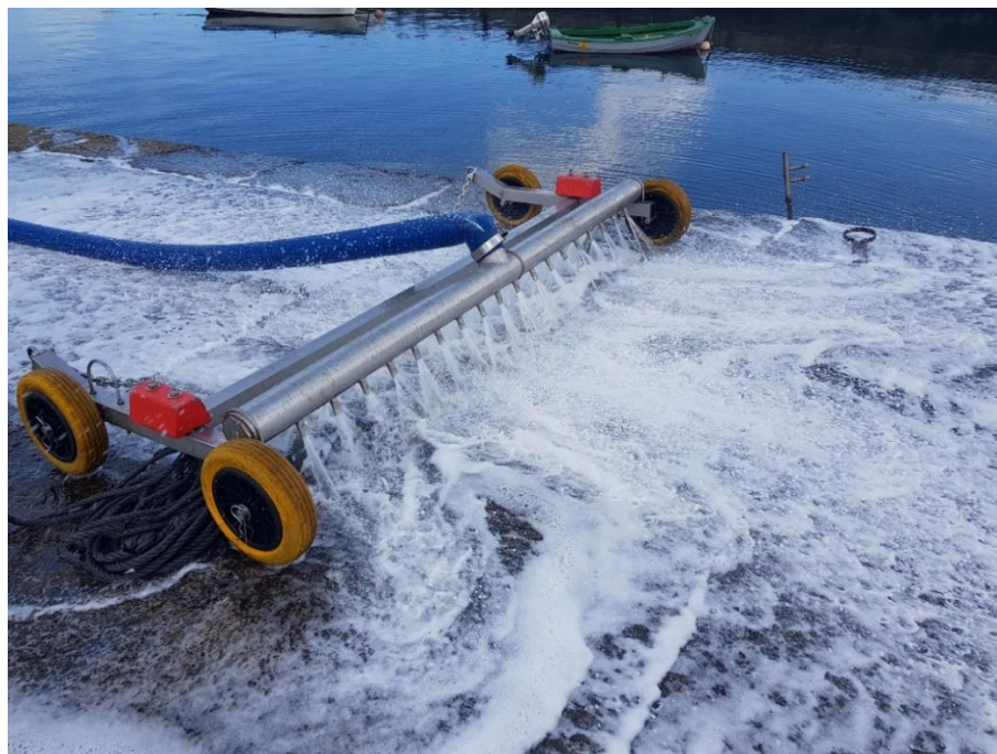
Aparello de remoción hidráulica para remolque con embarcación lixeira.
