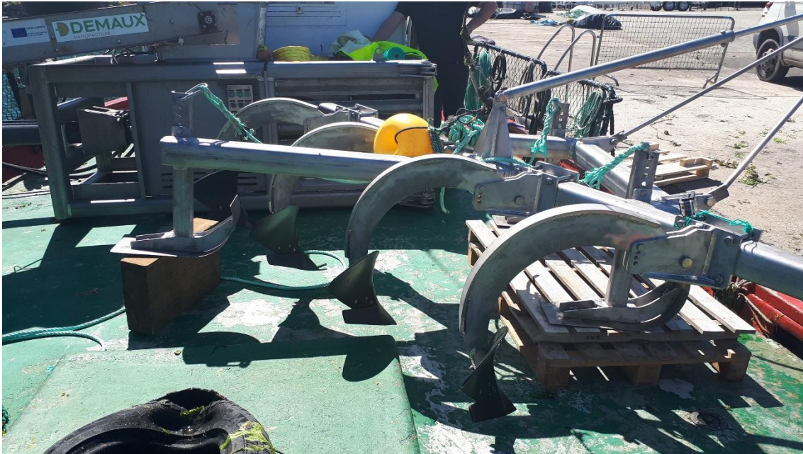
Imaxe 4. Arado de rexeneración de zonas improdutivas con catro pas regulables
